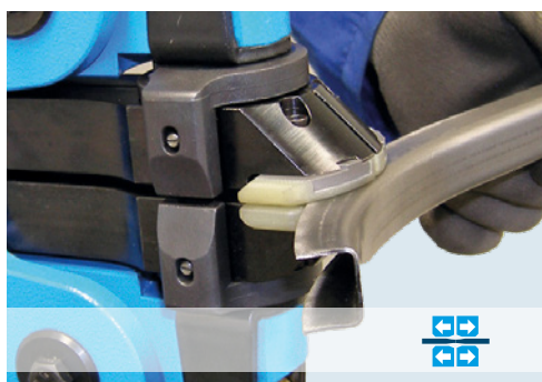
Anpassen und Strecken mit oberflächenschonendem Werkzeug / Correcting and stretching with no-mar tools
