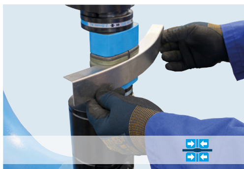
Stauchwerkzeuge für perfekte Oberflächen / Shrinking tools for perfect surfaces
