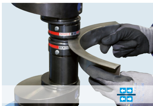
Strecken von Blechen und Profilen / Stretching sheet metal and profiles
