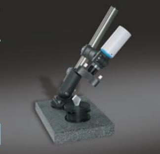
Micro-Interferometer VI direct zur Planoptikprüfung mit Prüfdurchmesser zwischen 0,8 mm und 3,6 mm.
