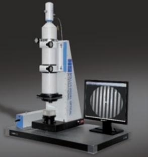
Messtation zur Prüfung von planen Flächen im Auflicht mit Phasenschieber.
